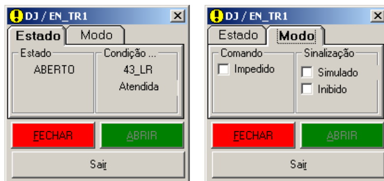
Figura 18: Janela de comando para disjuntores e seccionadoras
