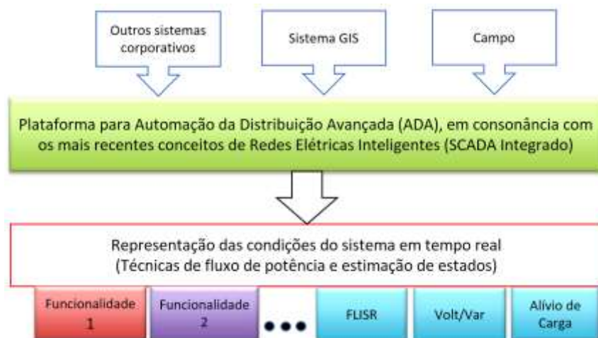
Fig 9 – Arquitetura do SCADA/ADMS
