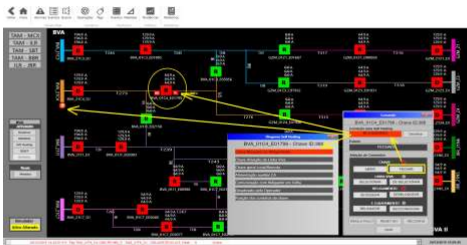
Fig 8 – Janela de comando de chaves de distribuição e janela com opções de bloqueio de chaves
